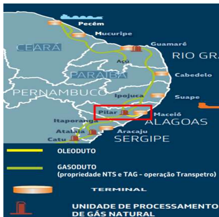
Figura 6: Rede de polos produtores, terminais e dutovias de petróleo e combustíveis – recorte do Estado de Alagoas Fonte: Elaboração interna, com base em dados Transpetro.
